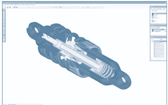
Erzeugen eines Schnittes im 3D-Modell, durch eine oder mehrere gewählte Komponenten
